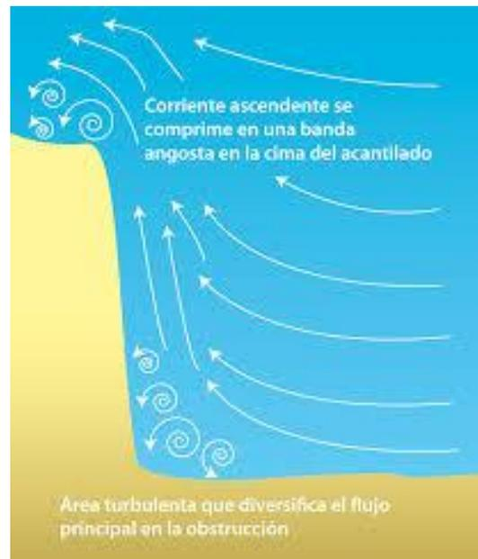
Fig. # 8 Esquema de la formación de un rotor por la interacción del viento sinóptico con una montaña (fuente: <http://www.kitesurf.com.uy/>)
